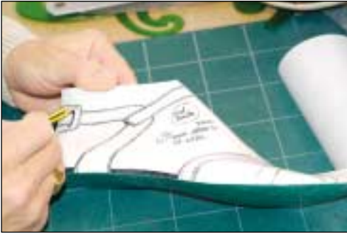
Dessin sur une forme : une des nombreuses phases préparatoires de la fabrication d'une chaussure.
